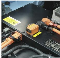
El diseño muy compacto y llamativo del mazo de cables de alta tensión.
