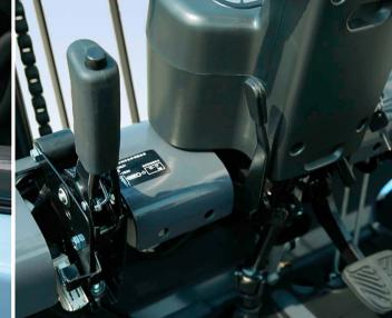
Frenos de estacionamiento regulable y ajuste conveniente de la columna de dirección
